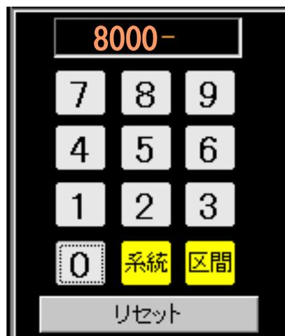
「リセット」ボタンをクリックすると、データが読み込まれた場合には右図のように停名部分に「系統設定(系統選別中)」運賃表示のデジタル部分の全部には、「8888」が数秒間表示されます。その表示が終わると、データの一番最初の行(系統名称)の表示が行われます。
